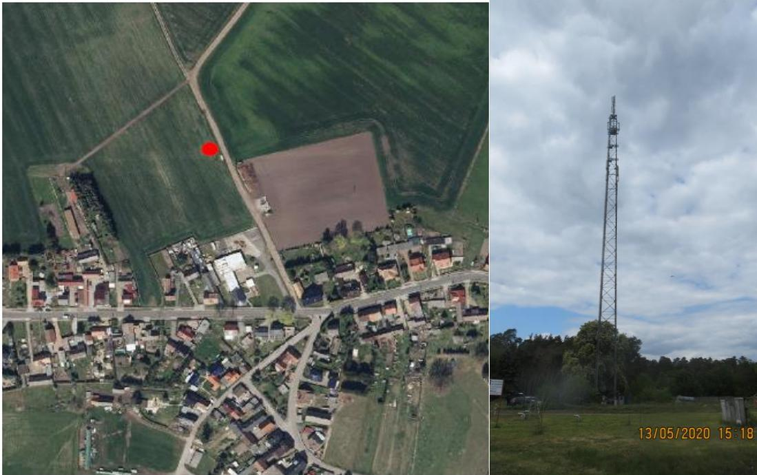
Im Bild sind der mögliche Standort und die Ausführung als Gittermast (ca. 40m Höhe) dargestellt. Durch Absprachen zwischen den verschiedenen Anbietern, soll eine Nutzung durch alle Anbieter und somit Abdeckung mit allen Netzen (4G Standard) ermöglicht werden.
